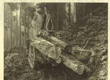
▲ フォワーダによる積み込み作業
