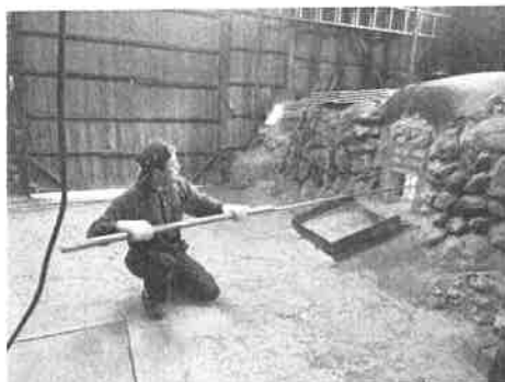
▲研磨炭の窯出し作業
